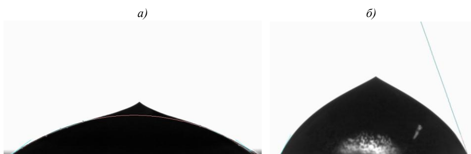
Рис. 3. Капли воды на поверхности покрытий на основе эпоксидного лака (а) и на основе полидиенуретана с эпоксидными концевыми группами и фторсилоксанового каучука (б) после замерзания
