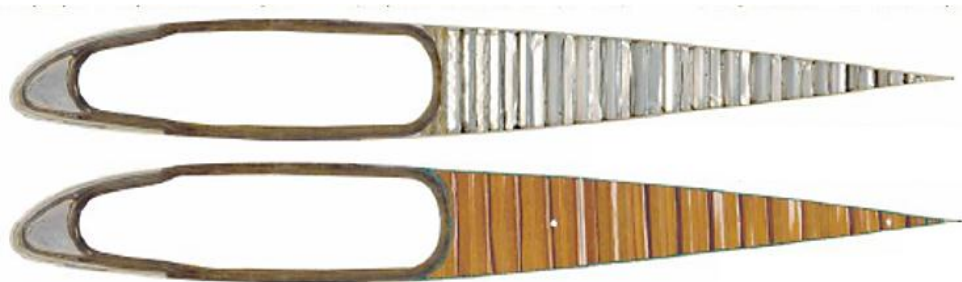
Рис. 1. Пример сечения существующих лопастей несущего винта (I–III этап развития конструктивно-силовых схем)
