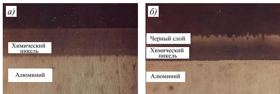
Рис. 3. Структура поперечного сечения химического никелевого покрытия до (а) и после (б) травления
