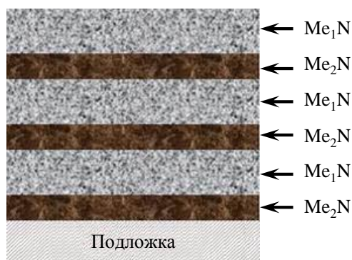
Рис. 1. Стандартная структура биметаллического покрытия типа (TiAl)N/TiN
