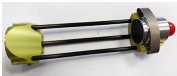
Рис. 4. Оснастка с коническим зеркалом, закрепленная на преобразователе
