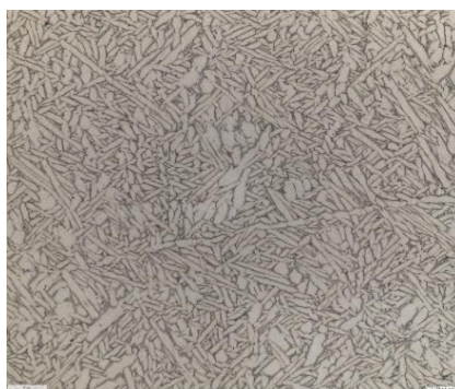
Рис. 5. Характерная структура синтезированного материала после горячего изостатического прессования и термической обработки
