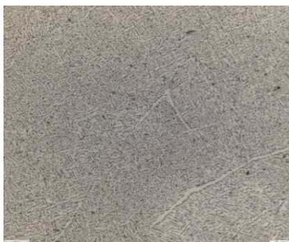
Рис. 4. Характерная структура синтезированного материала после селективного электронно-лучевого сплавления
