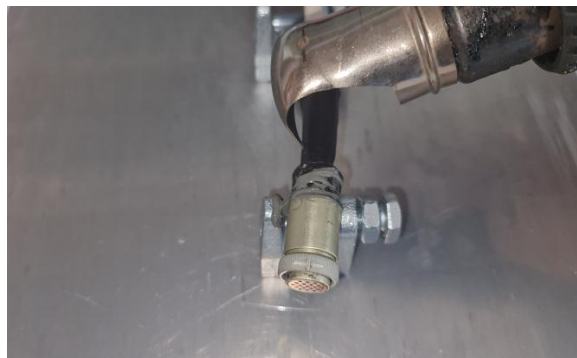
Рис. 4. Термоусадка трубки с помощью фена
