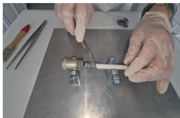
Рис. 2. Нанесение клея ВК-106 на склеиваемые поверхности
