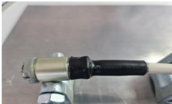
Рис. 5. Конструктивно-подобный образец «термоусаживаемый элемент + электрический разъем», изготовленный с использованием клея ВК-106
