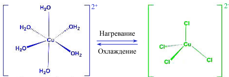
Рис. 1. Изменение цвета аквакомплекса меди (II) вследствие преобразования структуры и расположения лигандов
