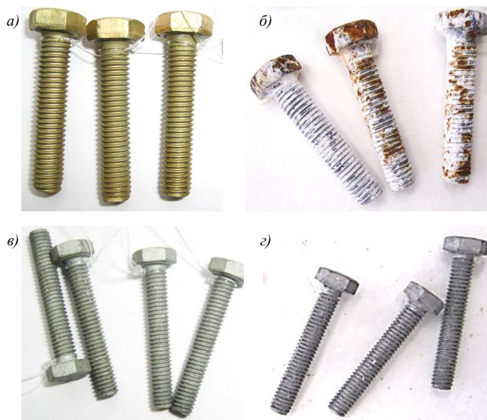
Рис. 4. Стальные болты с защитными гальваническими (а, б) и термодиффузионными (в, г) цинковыми покрытиями в исходном состоянии (а, в) и после экспозиции в камере солевого тумана в течение 2000 ч (б, г)
