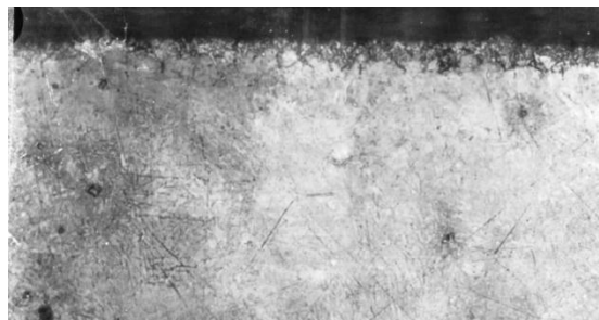
Рис. 3. Обезуглероженный слой на внутренней поверхности рессор в месте основного разрушения ( \times 500 )
