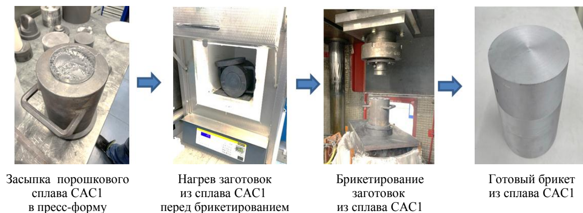
Рис. 3. Технологический процесс компактирования заготовок из сплава САС1
