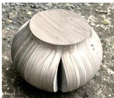
Рис. 8. Осаженный до разрушения образец из сплава SAC1
