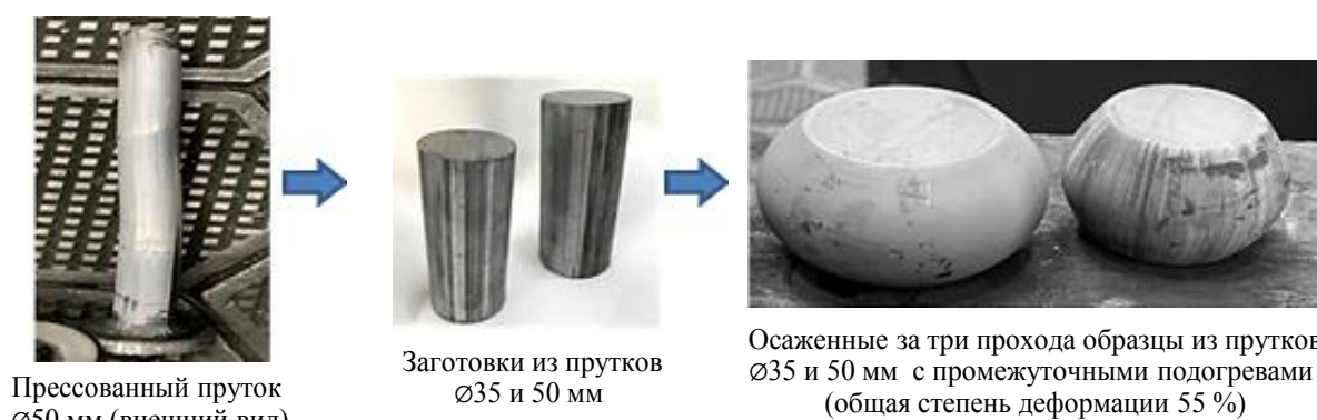
Рис. 9. Технологическая схема изготовления поковок из сплава SAC1 осадкой из прутков
