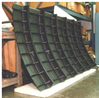
Рис. 8. Струнгерная панель из полимерных композиционных материалов на основе полиимидного связующего LaRC PETI-5 и углеродного волокна IM7 [30]
