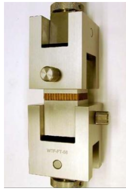
Рис. 7. Растяжение сотового заполнителя с помощью наклеенных блоков
