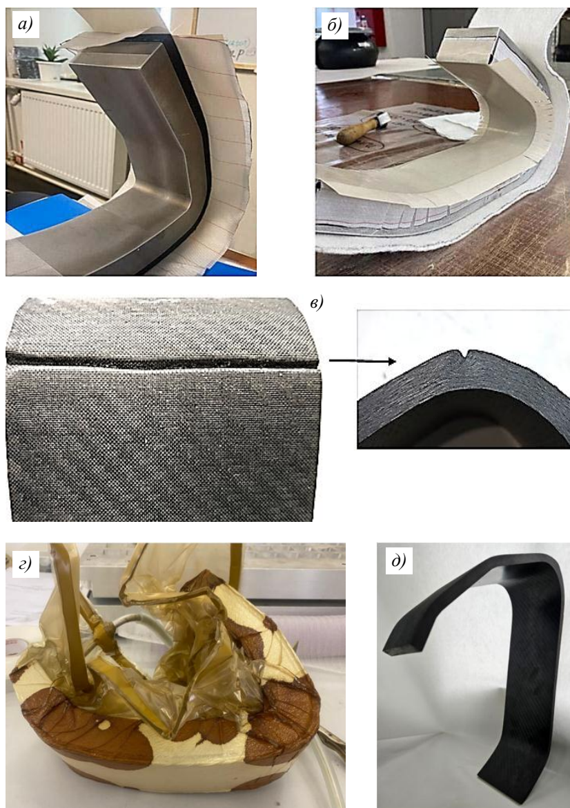
Рис. 8. Изготовление конструктивно-подобного элемента фрагмента модуля стопы с использованием препрега: а, б – сборка слоев наполнителя на внешней и внутренней сторонах оснастки; в – образование складки и «клюва» в материале при формовании без верхней цулаги; г – вакуумный пакет после проведения отверждения; д – отформованный образец
