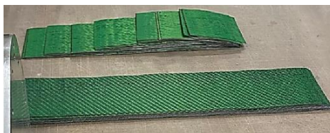
Рис. 5. Раскрой семипрегов перед выкладкой на формообразующую оснастку
