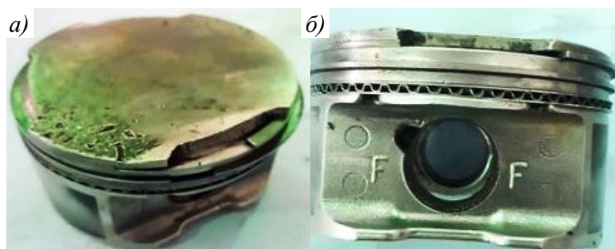
Рис. 11. Поршень с повреждением на верхней поверхности: а – вид сверху; б – вид сбоку
