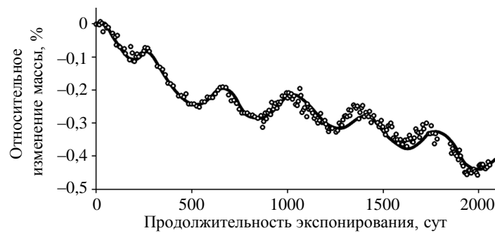
Рис. 1. Относительное изменение массы образца в процессе длительного экспонирования в натуральных условиях
