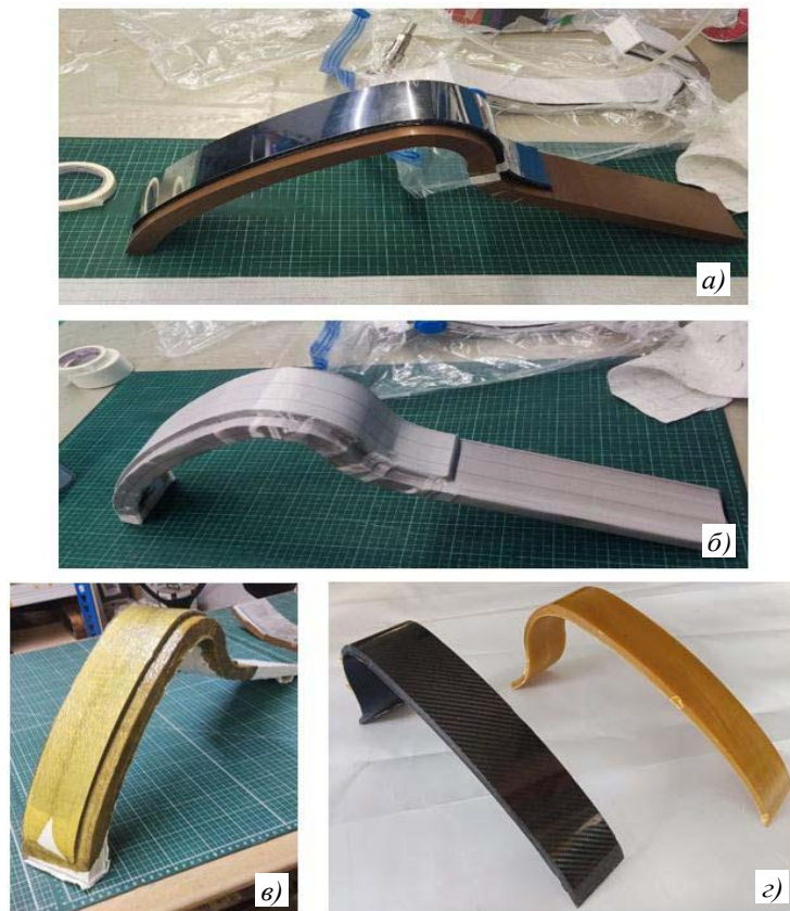
Рис. 6. Стадии подготовки сборки вакуумного технологического пакета: а – выложенный препрег на формообразующей оснастке с «лицевой» цулагой; б – сборка с жертвенной тканью; в – сборка после отверждения связующего; г – экспериментальные конструктивно-подобные образцы панелей корпусной конструкции сложной формы – фрагмента модуля стопы из угле- и стеклопластиков
