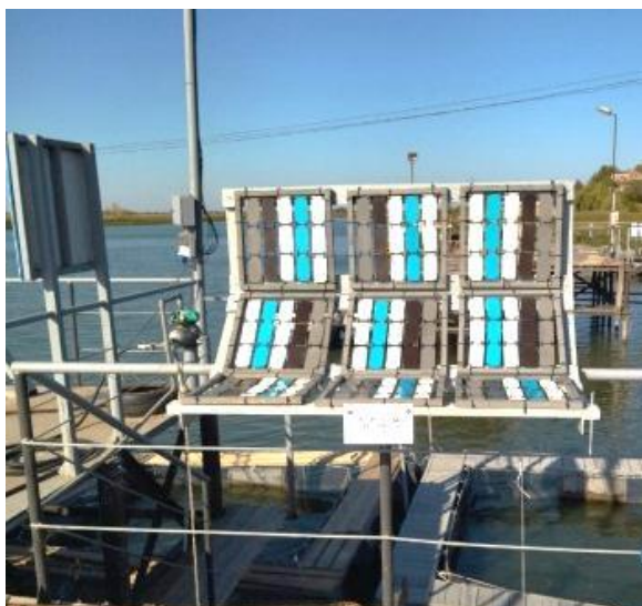
Рис. 1. Стенд с образцами лакокрасочных покрытий на площадке Южного научного центра РАН в с. Кагальник
