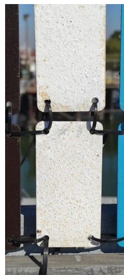
Рис. 2. Первые проявления коррозии на образцах с акрил-полиуретановой эмалью
