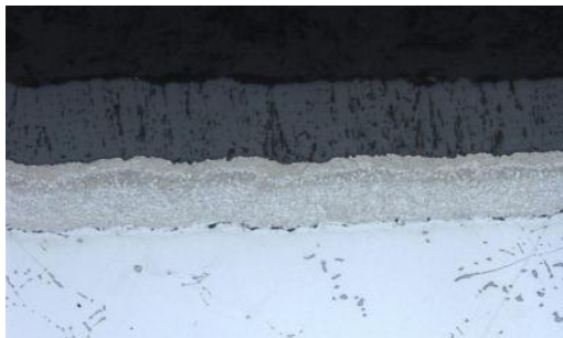
Рис. 6. Структура теплозащитного покрытия с магнетронным керамическим слоем [18]
