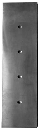
Рис. 7. Металлическая мишень для магнетронного распыления [17]
