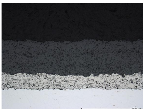
Рис. 10. Микроструктура теплозащитного покрытия с керамическим слоем, полученным методом атмосферно-плазменного напыления [24]
