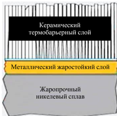
Рис. 1. Конструкция теплозащитного покрытия [5]
