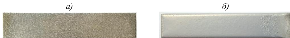
Рис. 1. Внешний вид образца до (а) и после (б) электролитно-плазменного полирования в растворе с добавкой лимонной кислоты (продолжительность обработки 30 мин)
