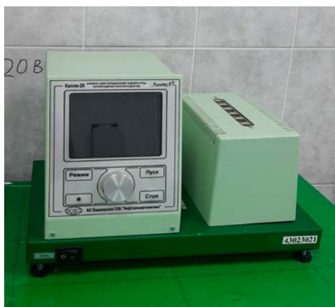
Рис. 5. Аппарат для определения температуры каплепадения нефтепродуктов
