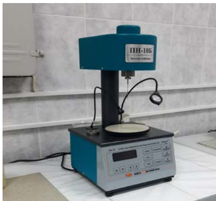
Рис. 4. Прибор для определения пенетрации нефтепродуктов
