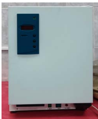
Рис. 2. Термостат для определения теплоустойчивости парафина
