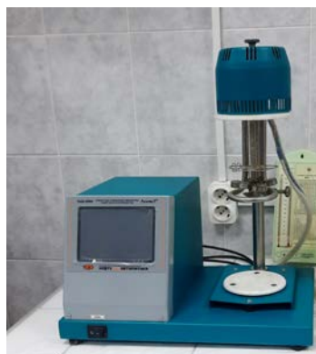
Рис. 3. Аппарат для определения температуры размягчения нефтепродуктов
