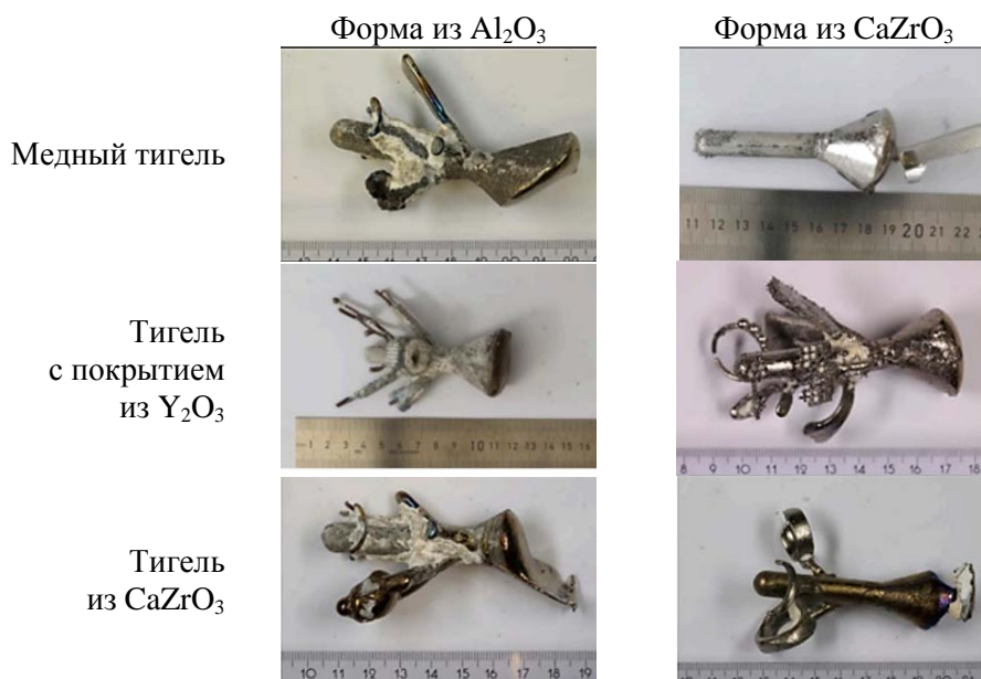
Рис. 12. Сравнительный анализ внешнего вида отливок, полученных с использованием разных материалов для тиглей и форм [18]
