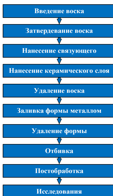
Рис. 2. Схема процесса изготовления отливок из титановых сплавов
