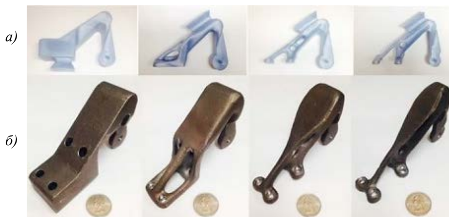
Рис. 4. Модели, полученные по технологии многоструйной печати (MJP) из воскоподобного материала ( а ), и отливки, изготовленные с их использованием ( б ) [13]
