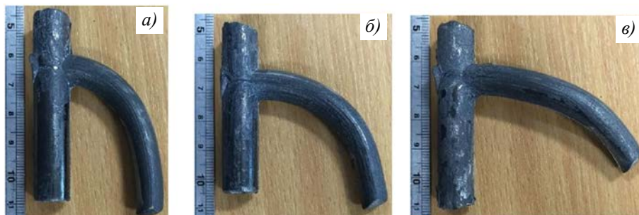
Рис. 3. Изменение кривизны изогнутого профиля при соотношениях скоростей деформации v_2 и v_1 1/3 (а), 1/2 (б) и 2/3 (в), при температурах 250, 300, 350 °С и скорости v_1 , равной 0,1 и 1 мм/с [14]
