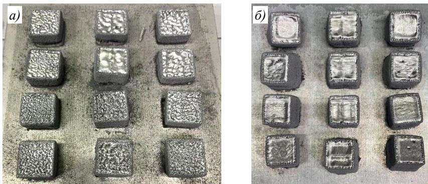
Рис. 6. Внешний вид образцов на первой (а) и третьей (б) итерациях отработки режимов синтеза
