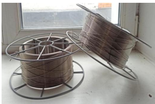
Рис. 3. Присадочная проволока для электродуговой наплавки (WAAM)
