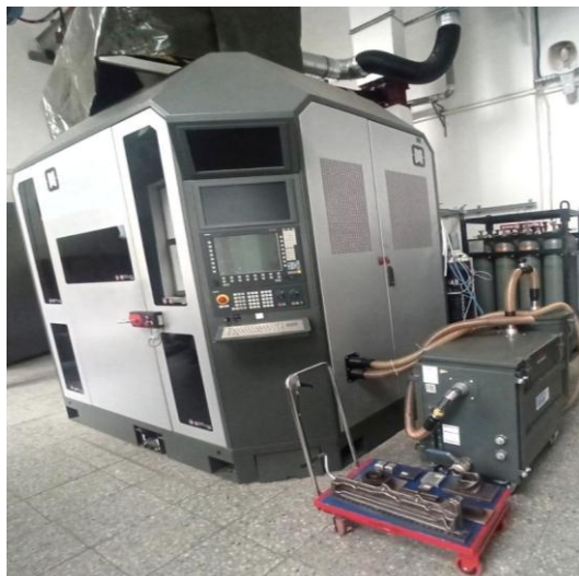
Рис. 2. Портальная установка для осуществления электродуговой наплавки (WAAM)
