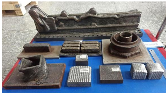
Рис. 1. Изделия, полученные методом электродуговой наплавки (WAAM)
