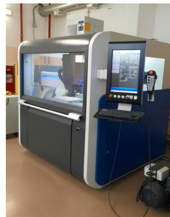
Рис. 6. Фрезеровочный станок для изготовления элементарных образцов углепластика
