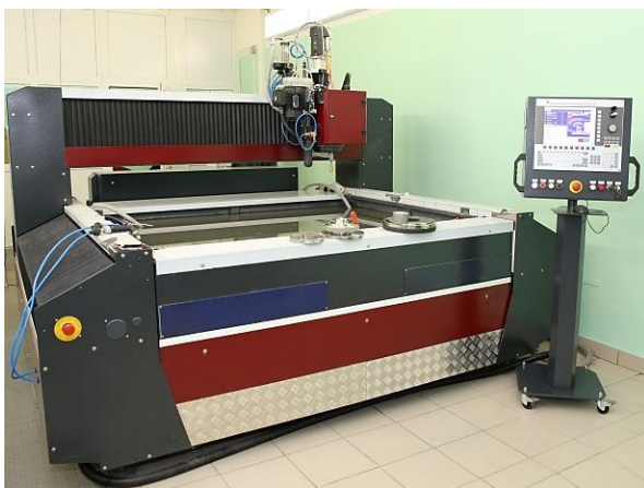
Рис. 5. Станок гидроабразивной резки ПКМ
