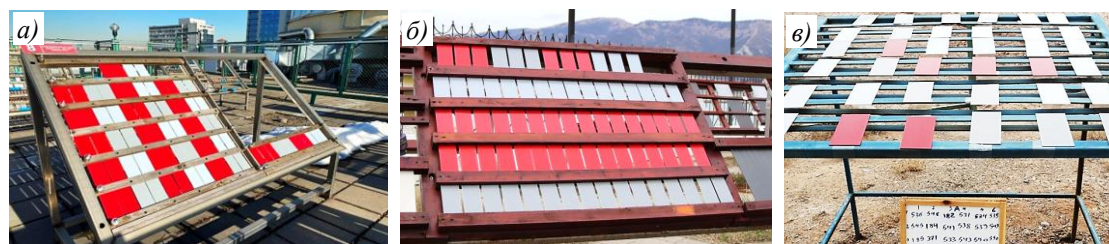
Рис. 2. Образцы алюминиевого сплава с нанесенными системами лакокрасочных покрытий на стендах для проведения экспонирования в условиях умеренного (а), умеренно теплого (б) и сухого субтропического климата (в)
