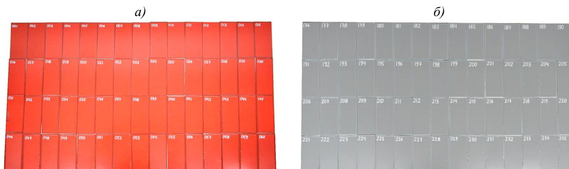
Рис. 1. Образцы алюминиевого сплава с нанесенной системой лакокрасочного покрытия на основе фторполиуретановой эмали ВЭ-69 с добавлением пигментов красного (а) и серого (б) цвета
