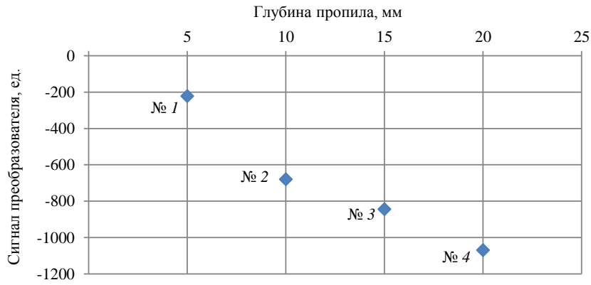
Рис. 12. Зависимость максимума сигнала преобразователя диаметром 5 мм от глубины пропилов № 1–4
