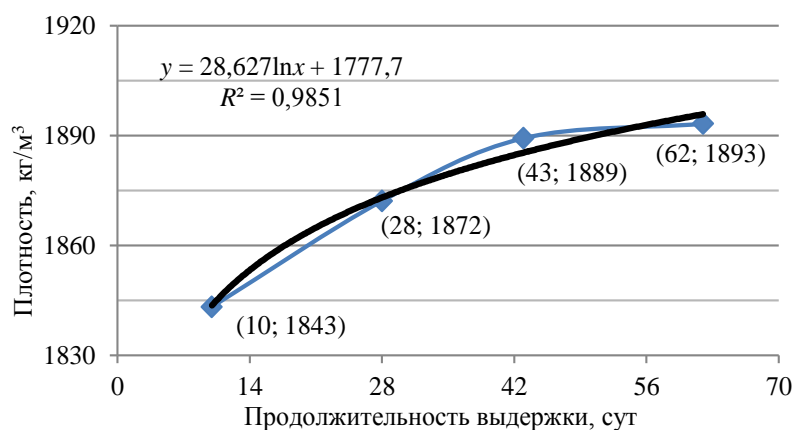
Рис. 5. Аппроксимация логарифмическим трендом зависимости плотности от продолжительности выдержки в воде стеклопластика на основе расплавленного эпоксидного связующего и ткани из стеклянных крученых комплексных нитей на основе полых волокон
