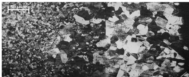
Рис. 10. Переходная зона в структуре гранулируемого жаропрочного никелевого сплава с функционально-градиентными характеристиками в разных зонах заготовки диска ГТД
