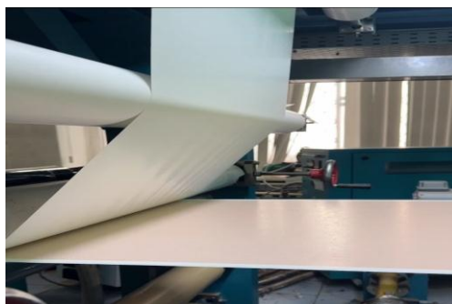
Рис. 1. Внешний вид полимерного пленочного покрытия с интегрированным металлическим слоем марки ВМЗП-1
