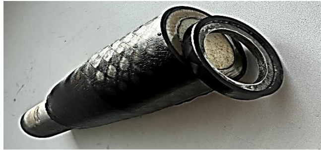
Рис. 11. Внутренняя структура заготовки элемента тяги управления
