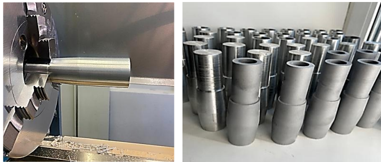
Рис. 6. Изготовление металлических закладных элементов
