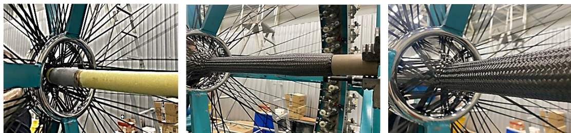
Рис. 8. Процесс оплетения оснастки с металлическими закладными элементами для изготовления заготовки элемента тяги системы управления углеродным волокном
