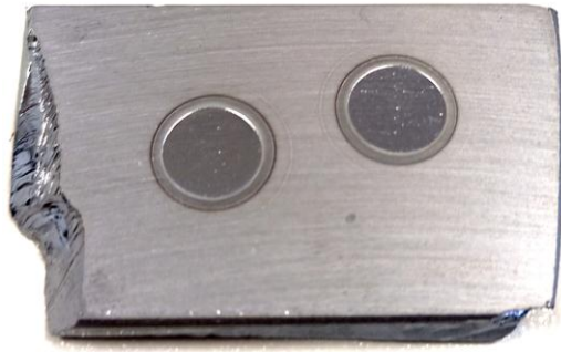
Рис. 2. Образец кремния после анализа методом масс-спектрометрии высокого разрешения с тлеющим разрядом
