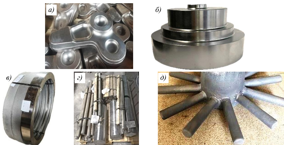
Рис. 1. Полуфабрикаты из сплава ВТ46 (ВТ46Л): а – штамповка, изготовленная с помощью молота, с габаритными размерами 343×263×92 мм и массой 14 кг; б – штамповка, изготовленная на изотермическом прессе, с габаритными размерами \varnothing 260 \times 150 мм, максимальным сечением под термическую обработку 96 мм и массой 25 кг в обточенном состоянии; в – цельнокатаные кольца (размеры одного кольца – диаметры D_{\text{нар}} = 945 мм, D_{\text{вн}} = 802 мм, высота стенки H = 100 мм, масса 86,5 кг); г – промышленные кованые и катаные прутки диаметром 35; 43 и 150 мм; д – опытная отливка для определения механических свойств диаметром 23 мм с фрагментом прибыли, после литья
