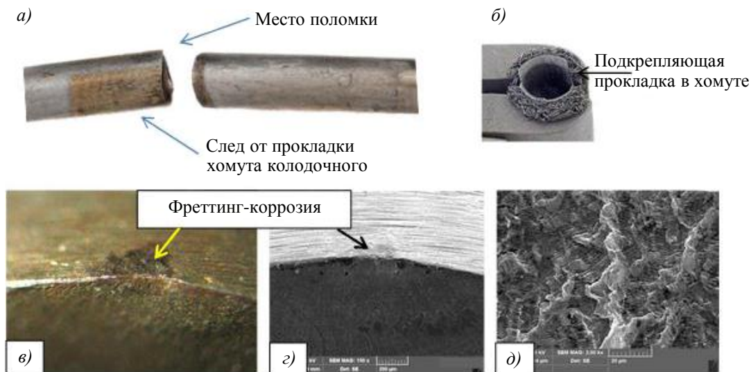
Рис. 1. Фреттинг-коррозия на поверхности трубы (а, в, з) и вид излома (з, д) по направлению усталостной трещины, образовавшейся при контакте с хомутом (б)
