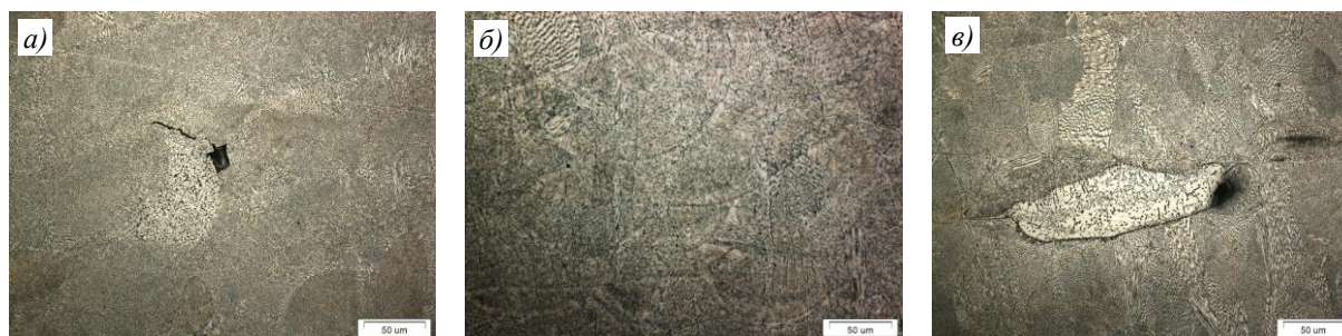
Рис. 5. Микроструктура после синтеза и термической обработки при плотности энергии \leq 80 (а), \leq 95 (б) и \leq 105 Дж/мм 3 (в)
