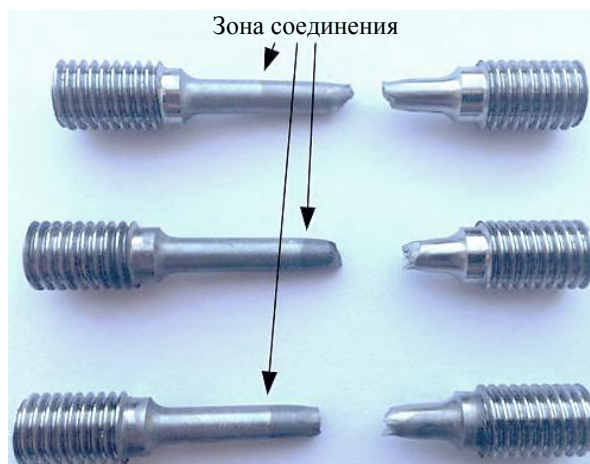
Рис. 4. Образцы из титановых сплавов VT8 и VT8M-1 из зоны соединения после испытаний на кратковременный разрыв [13]
