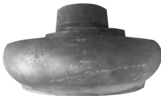
Рис. 7. Составная заготовка из сплавов типа ЭП975-ИД и ЭП742-ИД после заключительной изотермической деформации [13]
