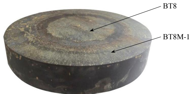
Рис. 2. Составная заготовка из сплавов ВТ8 и ВТ8М-1 после заключительной изотермической деформации [13]
