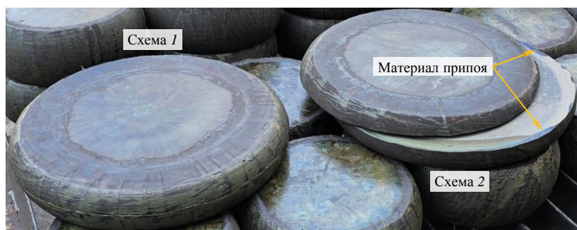
Рис. 8. Штамповки из составных заготовок, полученные в процессе изотермической деформации, после охлаждения на воздухе
