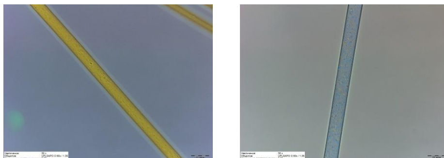
Рис. 9. Микроструктура моноволокон (оптическая микроскопия)
