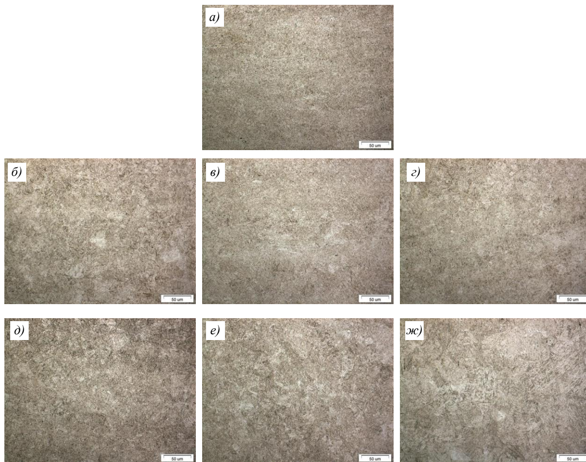
Рис. 2. Микроструктура ( \times 500 ) образцов после закалки с температур 900 (а), 950 (б), 975 (в), 1020 (г), 1080 (е) и 1110 °С (ж)
