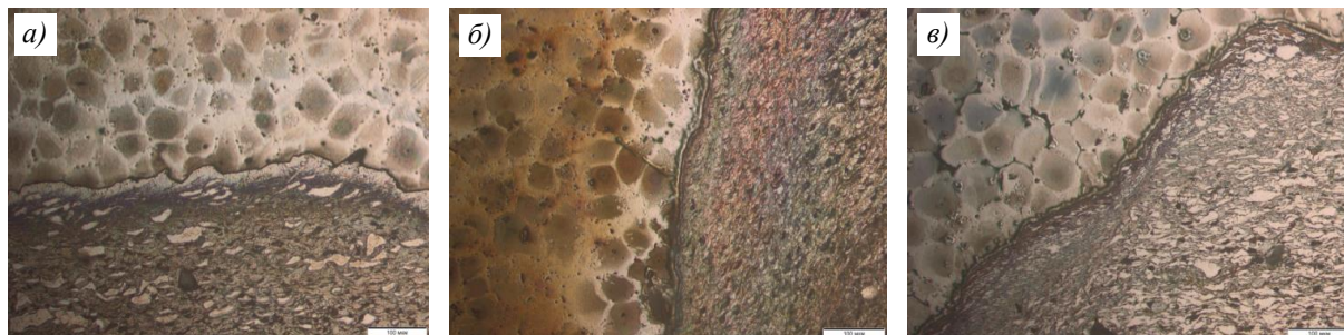
Рис. 4. Микроструктуры образцов из сплава ВМЛ20 с нанесенными порошковыми композициями (фракция частиц размером <10 мкм) составов 3 (а), 4 (б) и 5 (в)
