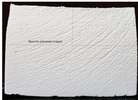
Рис. 2. Профиль образца материала после градиентного нагрева (показана линия, ниже которой эксплуатационная усадка угасает)
