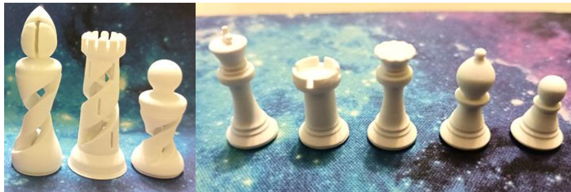
Рис. 13. Изделия, напечатанные из разработанных высоконаполненных керамических суспензий на основе оксида алюминия по технологии цифровой обработки светом
