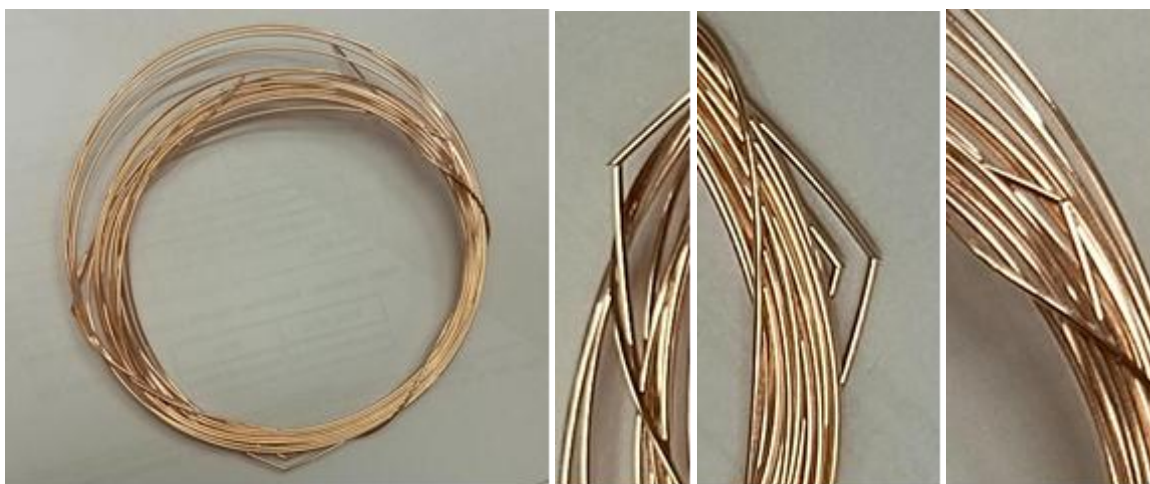
Рис. 1. Бухта припойной проволоки марки ПЗлМ 60В диаметром 0,6 мм с изломами
