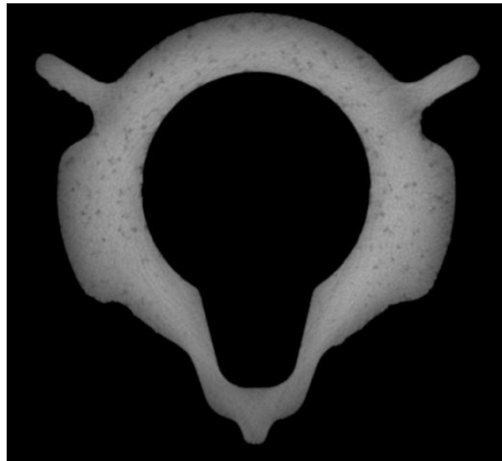
Рис. 7. Сечение фрагмента заготовки корпуса с изображением пористости
