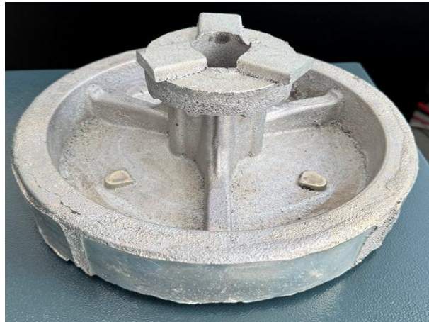
Рис. 1. Отливка заготовки корпуса из алюминиевого сплава АК9ч
