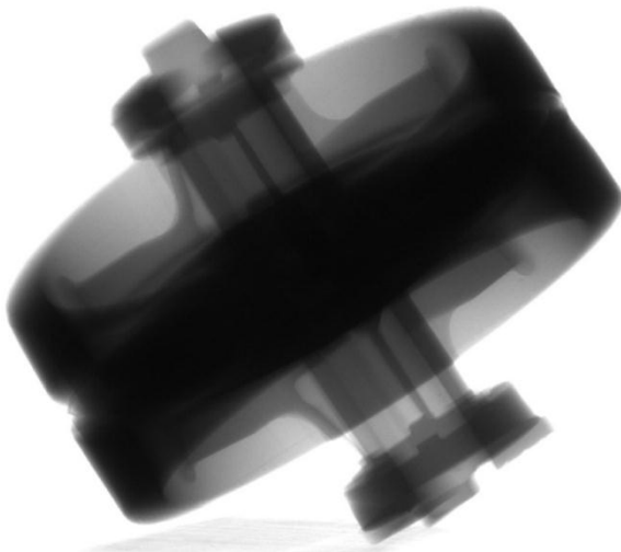
Рис. 2. Проекционное изображение пары отливок
