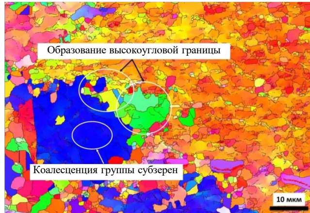
Рис. 4. Образование высокоугловой границы в экспериментальном сплаве в процессе горячей пластической деформации путем коалесценции группы субзерен
