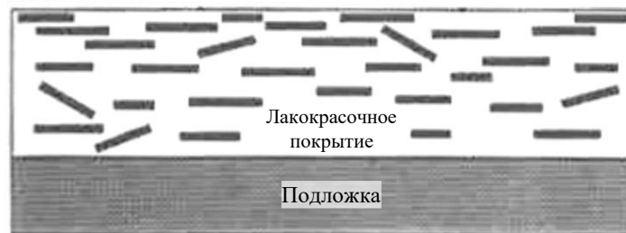
Рис. 1. Схема распределения чешуйчатых (пластинчатых) наполнителей
